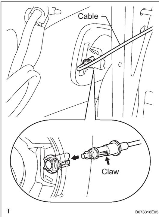
**2. INSTALL FUEL LID LOCK CONTROL CABLE SUB-ASSEMBLY**
