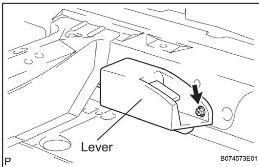
**3. INSTALL FUEL LID LOCK OPEN LEVER SUB-ASSEMBLY**
