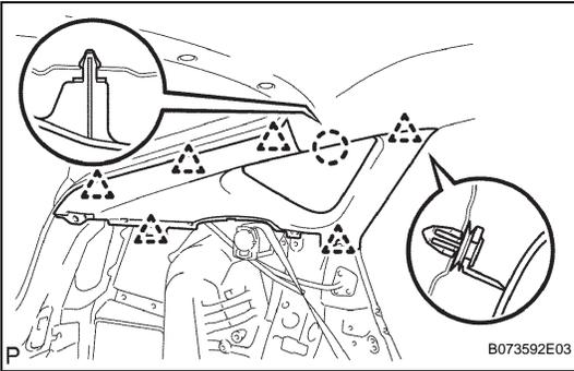
**9. INSTALL ROOF SIDE INNER GARNISH ASSEMBLY LH**
