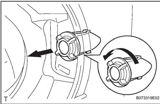
**12. REMOVE FUEL FILLER OPENING LID LOCK RETAINER**
