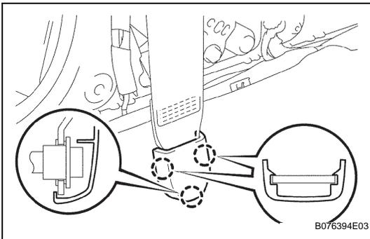
**20. DISCONNECT FRONT SEAT OUTER BELT ASSEMBLY LH**
